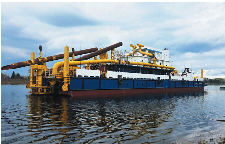
К концу 2024 года будут построены семь земснарядов проекта 4395 производительностью 700 куб. м/час. Фото: morflot.ru
