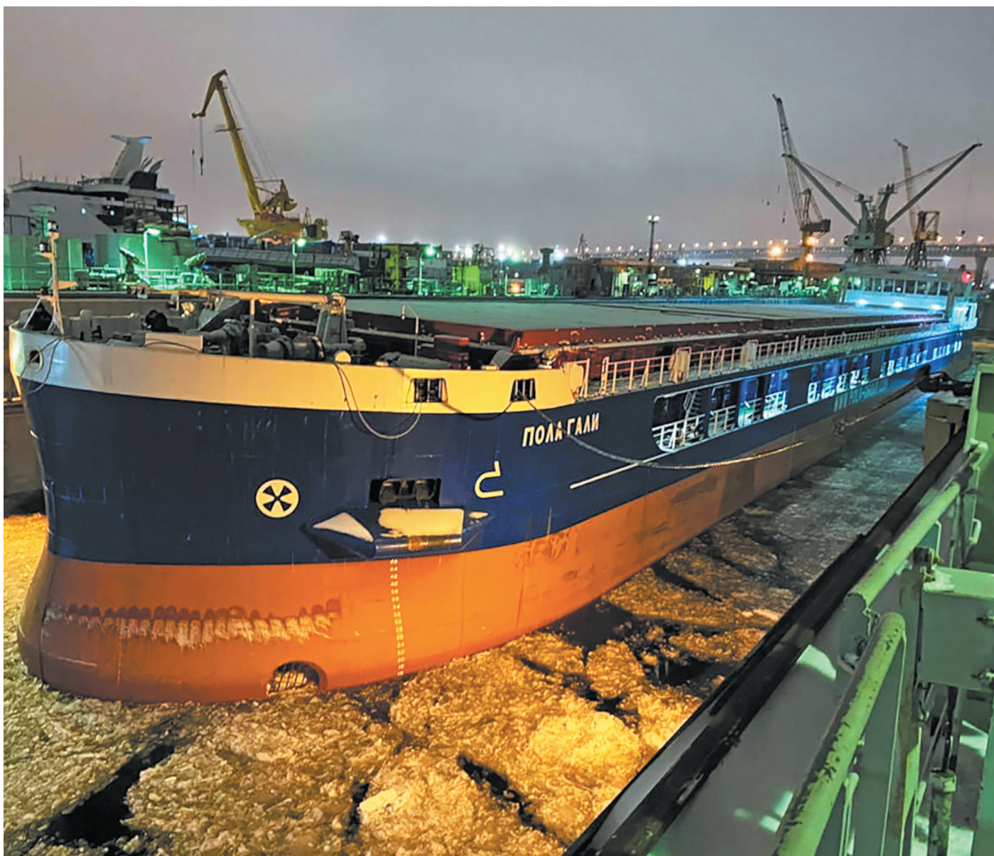
Наиболее востребованными продолжают оставаться сухогрузные суда класса «Волго-Дон макс» проекта RSD59. Сухогруз «Пола Гали», третье судно в серии из пяти судов, строящихся на Невском судостроительно-судоремонтном заводе, сдано в феврале 2021 года. Фото: aooks.ru
